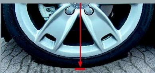
Une compression statique conduit au « plat » du pneu
