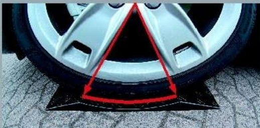
Une meilleure répartition de la pression permet d'éviter le « plat » du pneu
